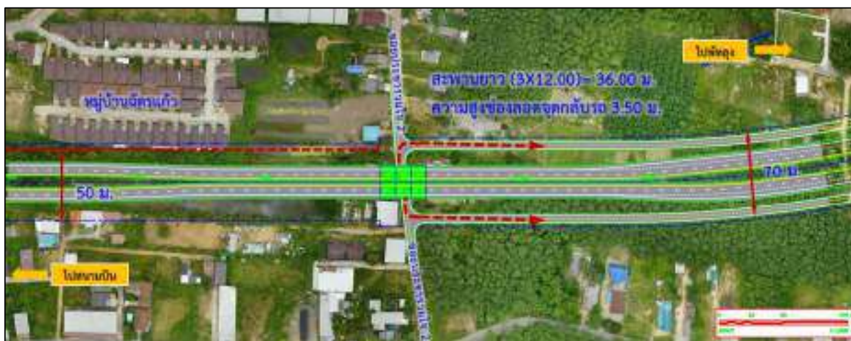
รูปที่ 18 รูปแบบจุดกลับรถ กม. 1+308 สะพานข้ามถนนซอยประชาร่วมใจ ความสูงช่องลอดทางตั้ง 3.50 เมตร
