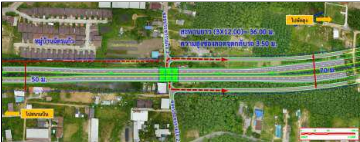
รูปที่ 19 รูปแบบจุดกลับรถ กม. 3+003 สะพานข้ามคลองสอ ความสูงช่องลอดทางตั้ง 4.50 เมตร
