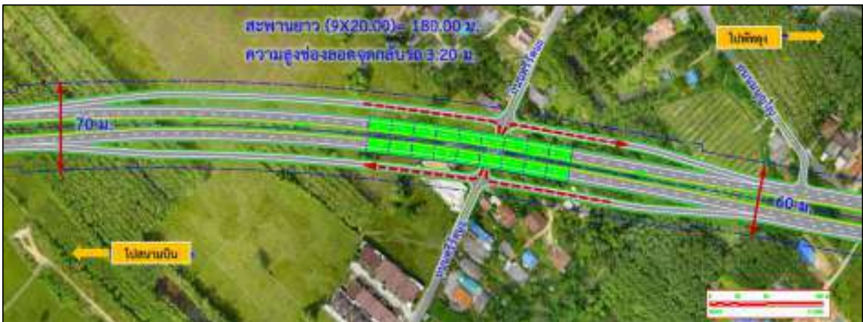
รูปที่ 20 รูปแบบจุดกลับรถ กม. 4+868 สะพานข้ามถนนศรีรัตน ความสูงช่องลอดทางตั้ง 3.20 เมตร
