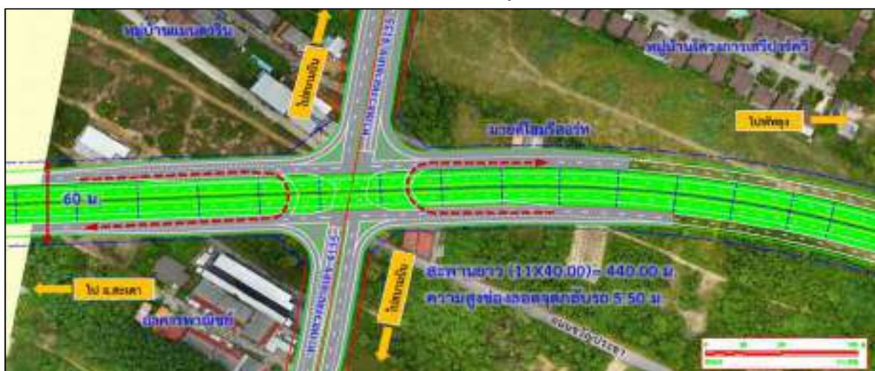
รูปที่ 17 รูปแบบจุดกลับรถ กม. 0+000 สะพานข้าม ทล. 4135 ความสูงช่องลอดทางตั้ง 5.50 เมตร
