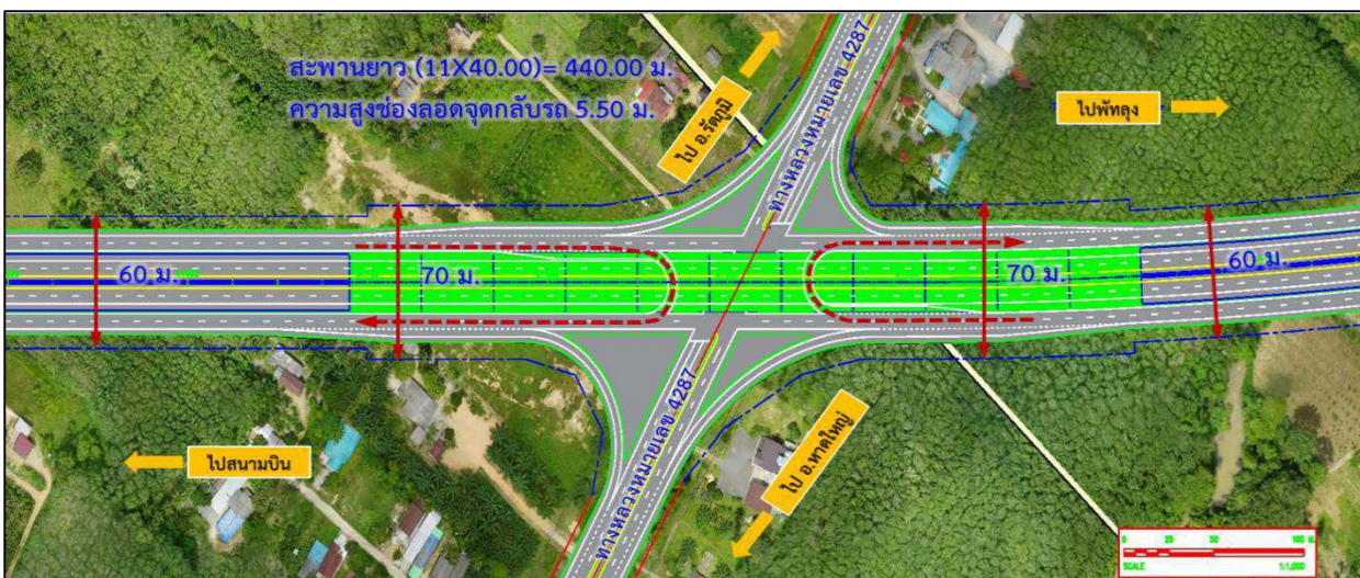
รูปที่ 21 รูปแบบจุดกลับรถ กม. 5+907 สะพานข้าม ทล. 4287 ความสูงช่องลอดทางตั้ง 5.50 เมตร
